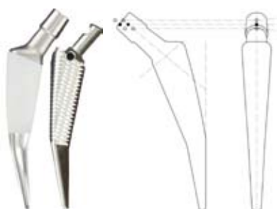
Abb. 1: AIDA, Monoblockschaft, Verdichter und Prothese haben identischen Durchmesser. Das „Press-fit“ wird durch die cpTi-Beschichtung ( \pm 250\ \mu\text{m} ) und die HA-Beschichtung ( \pm 90\ \mu\text{m} ) erzeugt. Die Skizze zeigt die verschiedenen Offset-Varianten (CCD 125^\circ/130^\circ ).
